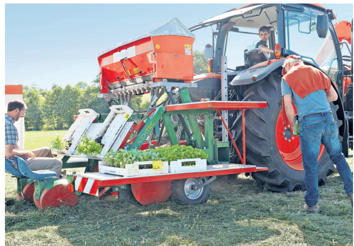
Mit der neuen MulchTec-Pflanztechnik können Gemüsejungpflanzen in eine geschlossene Mulchdecke gepflanzt werden.
