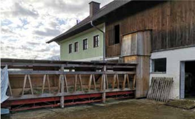
Der Landwirt hat seine Raufe im Auslauf mit einem alten „Höhenförderer“ ausgebaut. Dieser ist über die Tenne mit Heu bestückbar und transportiert das Futter per Knopfdruck automatisch entlang der Raufe.
